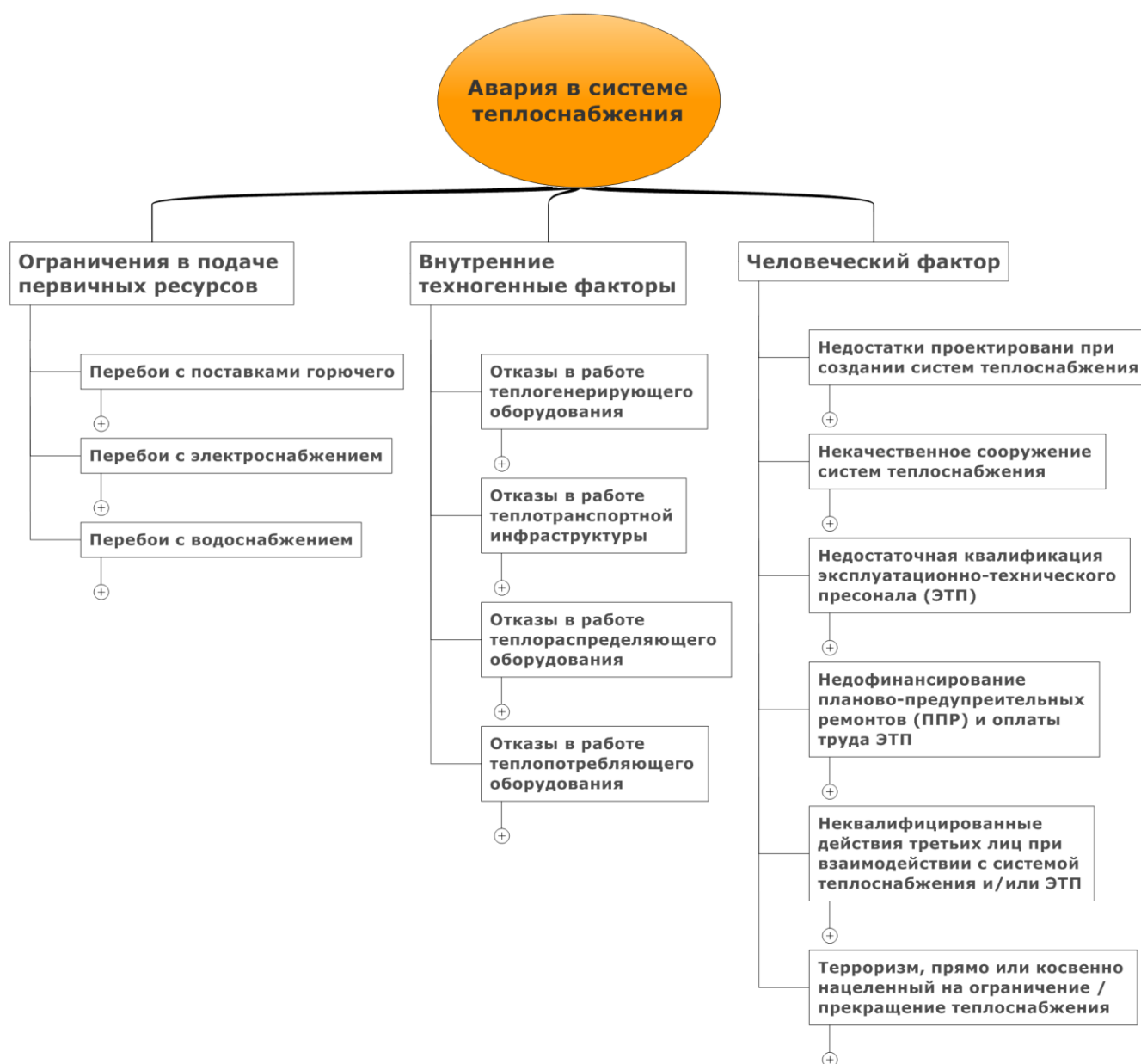
Рисунок 1 – Базовые причины аварий систем теплоснабжения
